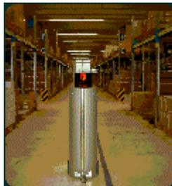
Robot de vigilancia interior para áreas amplias. Robowatch
