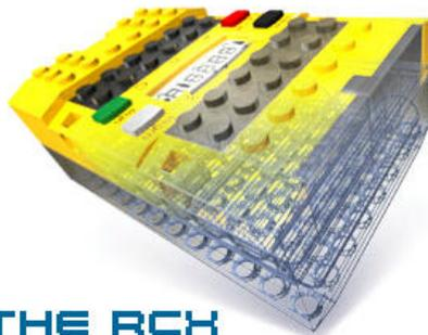
LEGO MINDSTORMS, construcción Lego que puede incorporar accionadores, sensores, un microcontrolador y comunicaciones para la construcción de robots. Lego (<http://mindstorms.lego.com>).
