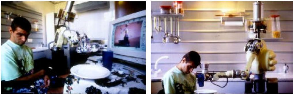
Persona con imposibilidad de controlar las extremidades superiores que está siendo ayudada a comer por un robot manipulador implantado sobre una estación de trabajo móvil (Movaid Project).
