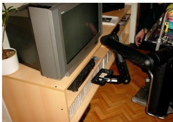
Assistive Robotic Manipulator (ARM), manipulador para su instalación en una silla de ruedas. Exact Dynamics (Holanda, <http://www.exactdynamics.nl/>).
