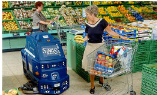
Robot de limpieza con el software de navegación SINAS.
