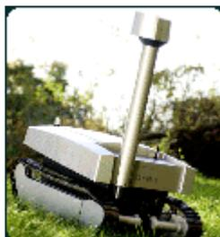
OFRO. Robot de vigilancia exterior para áreas amplias. Robowatch
