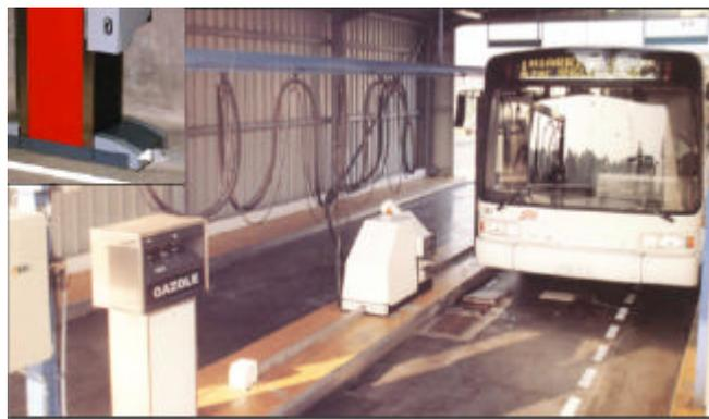
RobuFill. Robot de llenado para grandes flotas de transporte.
