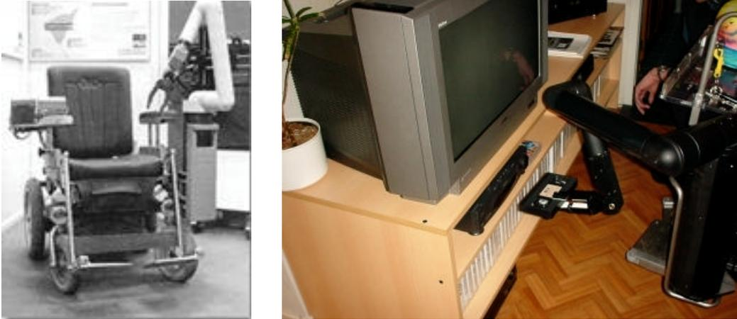
Dos vistas del *Assistive Robotic Manipulator* (ARM) manipulador para su instalación en una silla de ruedas de *Exact Dynamics*. <http://www.exactdynamics.nl/>.
