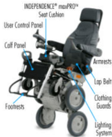
La silla iBot <http://www.independencenow.com/ibot/> tiene la habilidad de elevarse hasta la altura de la gente y subir escaleras.
