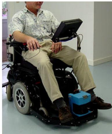
Silla de ruedas con capacidad de movimiento autónomo que actualmente comercializa la empresa *Active Media* <http://www.activrobots.com/ROBOTS/>.
