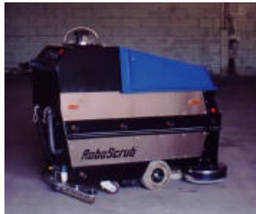
RoboScrub, robot de limpieza industrial guiado por láser.
